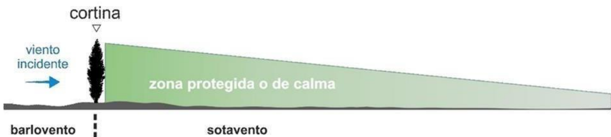
Figura 8. Esquema de perfil de una cortina y sus zonas de barlovento y sotavento.
